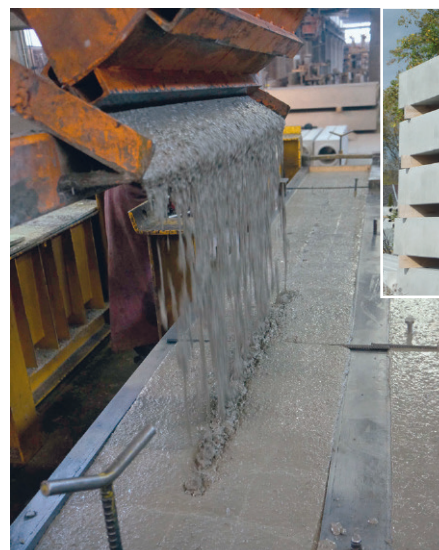
Bild 6: Hoch belastbare Drainagebauteile mit Microsit ®
